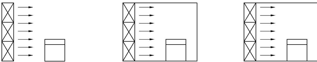
图 A.2 水平单向流的气流形式
